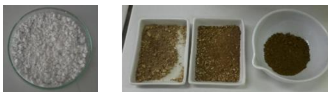
Figure 29 : Changement de couleur après imprégnation et calcination : SBA-15 parente (à gauche) ; Ag-SBA-15(10%), Ag-SBA-15(20%) et Ag-SBA-15(40%) respectivement (à droite).
