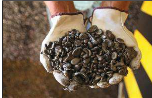
Figure 2 : Pépites de ferronickel (www.sln.nc) obtenues par traitement pyrométallurgique du minerai de nickel.
