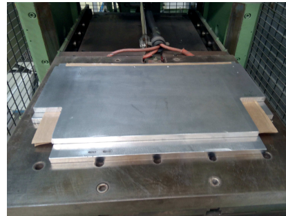
(b) Moule contenant les bandes à compresser mis en place dans la presse
