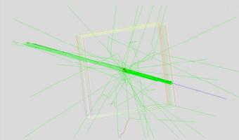
Fig. 5.48 Le passage dans les chambres d'un muon et de photons simulés par GEANT4.
