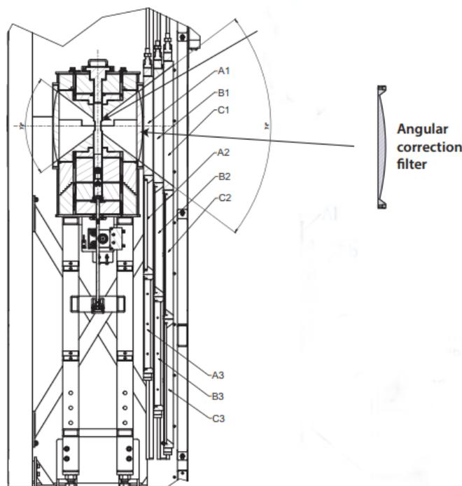
Fig. 5.42 Schéma de l'irradiateur et des systèmes d'atténuateurs.
