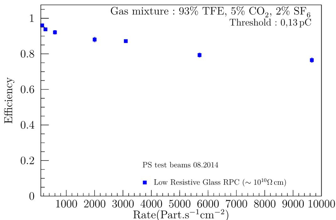
Fig. 5.30 Efficacité en fonction du flux de particules. La tension est fixée à 7200 V.
