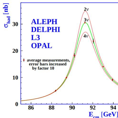
Fig. 1.24 Mesures de la section efficace de production hadronique près de la résonance du  $Z^0$ . Les courbes indiquent les sections efficaces prédites pour deux, trois et quatre espèces de neutrinos de masses négligeables avec les couplages du Modèle Standard [3].
