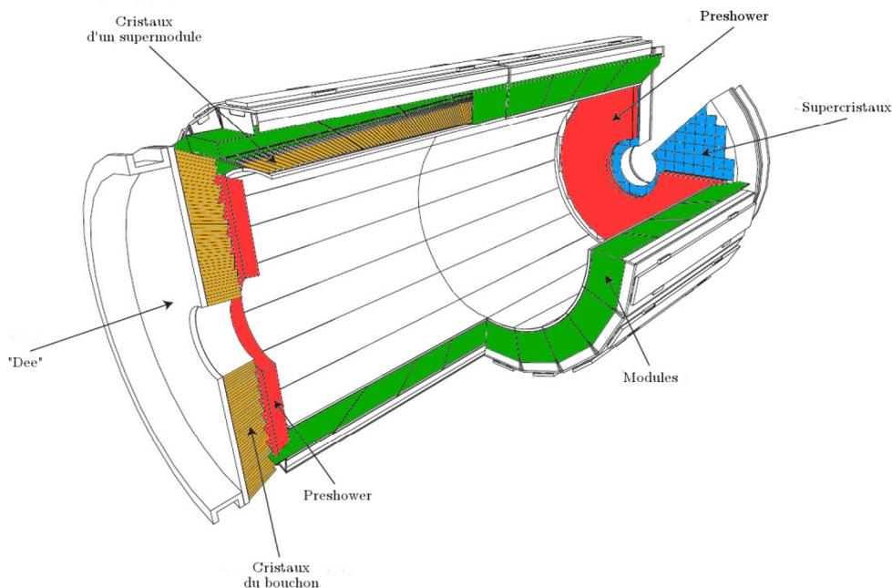
Fig. 3.9 Schéma du ECAL de CMS [12].
