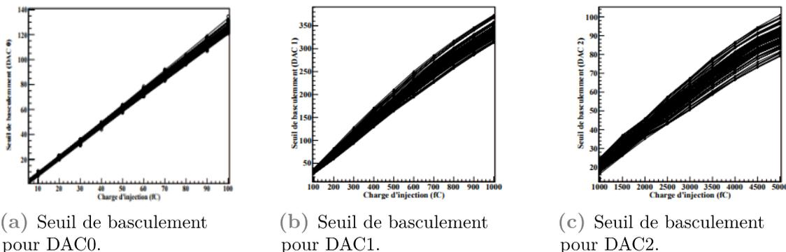
Fig. 5.15 Seuil de basculement pour DAC0, DAC1 et DAC2, en fonction de la charge injectée, pour 64 canaux d'un HARDROC. La valeur du piédestal a été soustraite [56].
