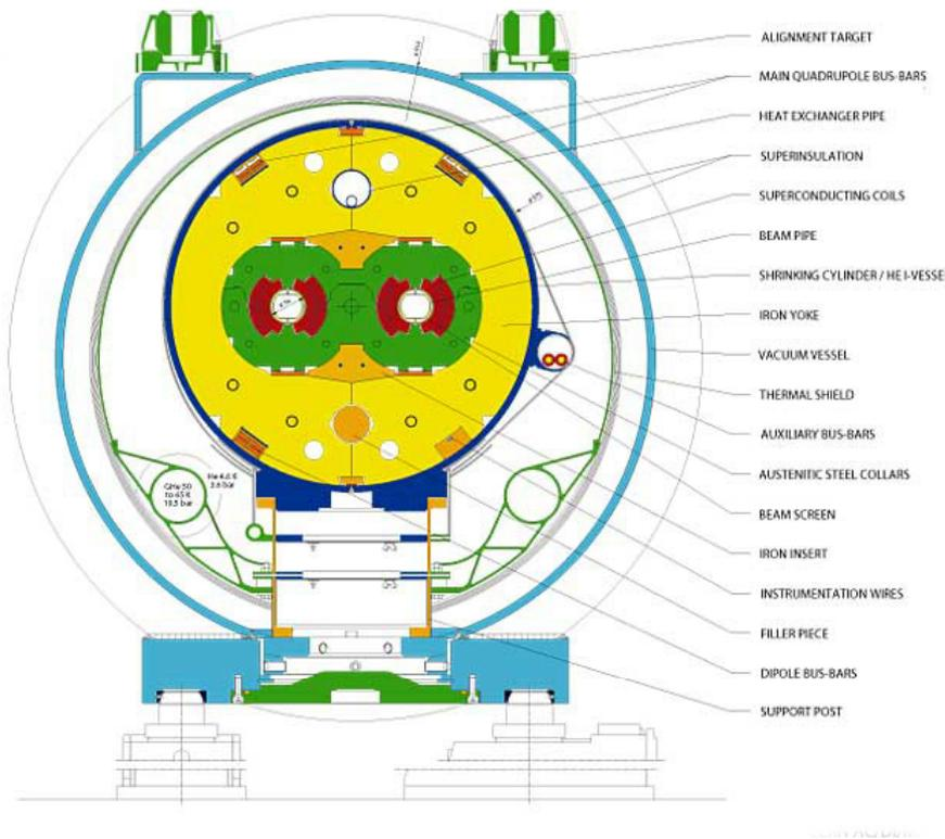
Fig. 2.16 Vue transversale d'un dipôle du LHC.
