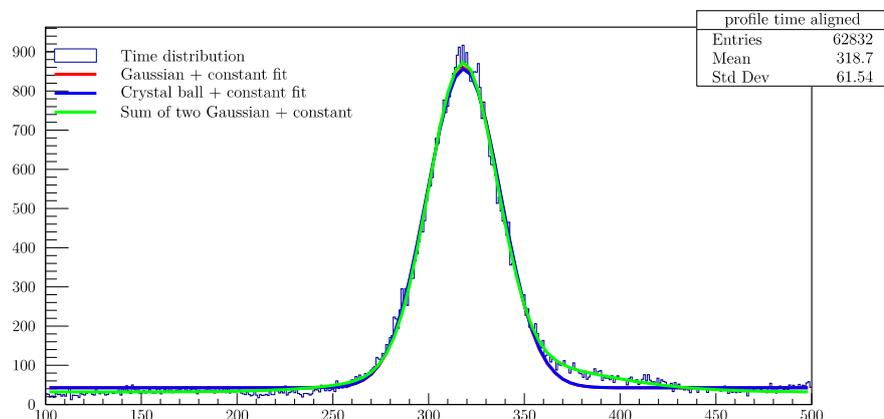
Fig. 5.79 Distribution du nombre de *hits* par *timestamp* des *strips* alignés et ajustement de cette distribution par la somme d'une gaussienne et d'une constante (vert), la somme de deux gaussiennes et d'une constante (rouge) et une Crystal-Ball (bleu).
