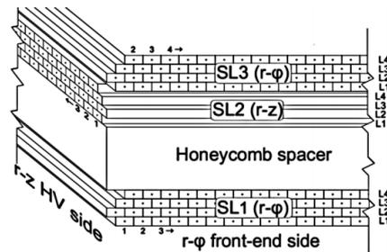
Fig. 3.28 Schéma d'une chambre à dérive [16].
