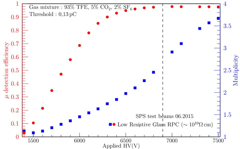
**Fig. 5.34** Efficacité (axe de gauche) et multiplicité (axe de droite) en fonction de la haute tension appliquée.
