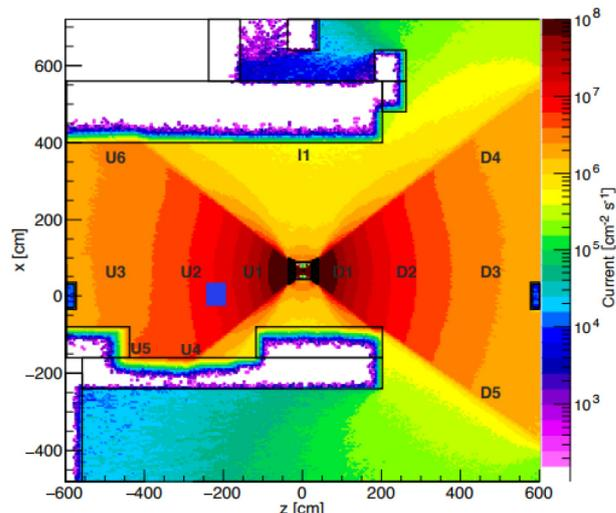
Fig. 5.46 Courant de photons total ( $\gamma$  de toutes énergies de 0 keV à 662 keV) dans le plan  $xz$  pour  $y = 0$  m. La position du télescope est indiquée par le carré bleu.
