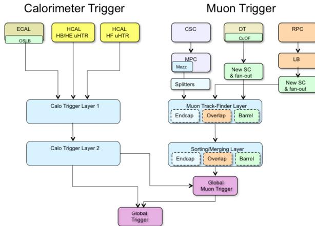
Fig. 3.36 Schéma du nouveau L1 pour la partie calorimètre et muons [22].
