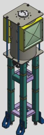
Fig. 5.41 Vue en trois dimensions de l'irradiator.
