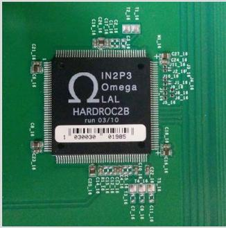
Fig. 5.7 Vue d'un HARDROC soudé.
