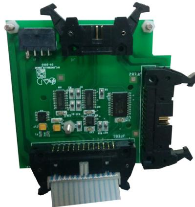
Fig. 4.30 Un DB permettant les configurations des paramètres des FEB par I<sup>2</sup>C ainsi que leur alimentation.
