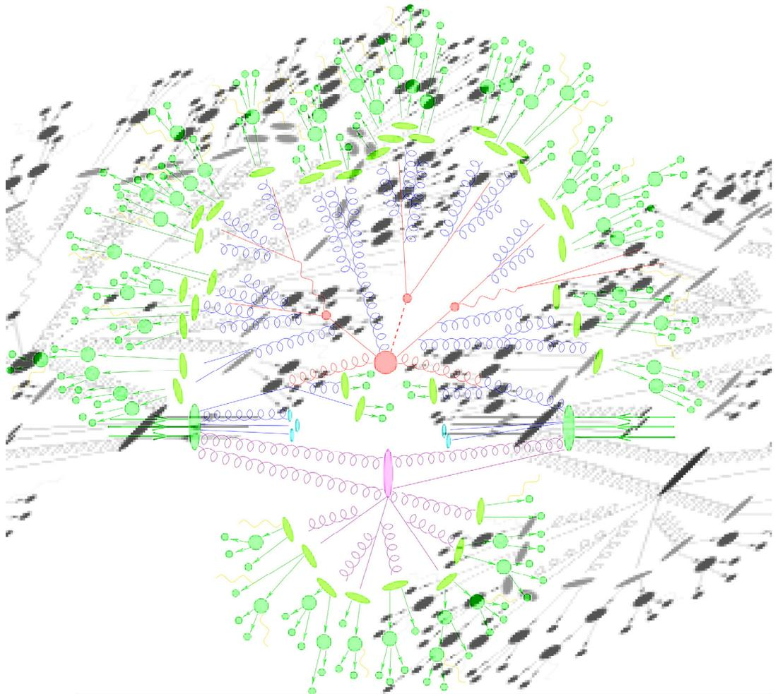
Fig. 2.24 Schéma d'une collision proton-proton inélastique. Deux partons venant de deux protons différents interagissent inélastiquement (rouge), d'autres partons de ces deux protons produisent des collisions secondaires (magenta). Les partons ainsi créés s'hadronisent (rouge) en créant des jets de particules (vert clair). Ces particules instables se désintègrent, en cascade, en particules stables (vert foncé).
