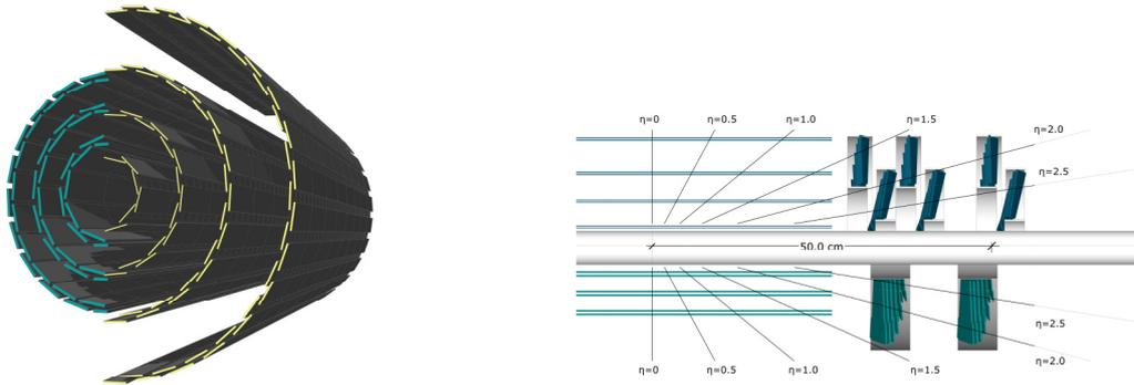
(a) Vue oblique-transverse comparant les couches des tonneaux de l'ancien (gauche) et du nouveau détecteur (droite).
