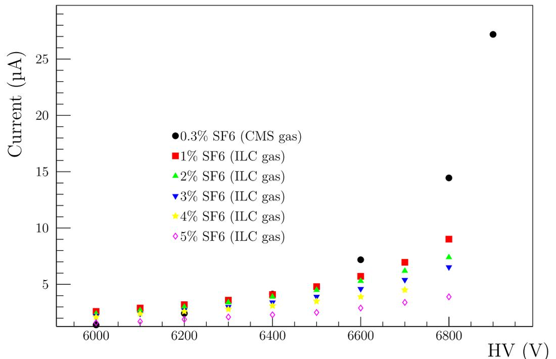
**Fig. 5.90** Courant dans la chambre RE1/1 en fonction du pourcentage de  $SF_6$  dans le mélange de gaz de type ILC (TFE,  $CO_2$ ,  $SF_6$ ), ainsi que pour le mélange de gaz CMS.
