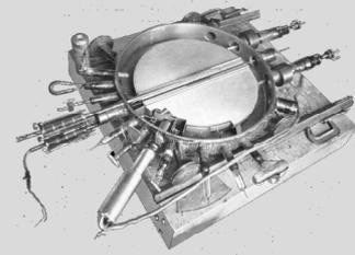
Fig. 1.4 Cyclotron de 27 pouces, accélérateur de  $^2\text{H}$  à 4 MeV (Université de Berkeley, 1932).
