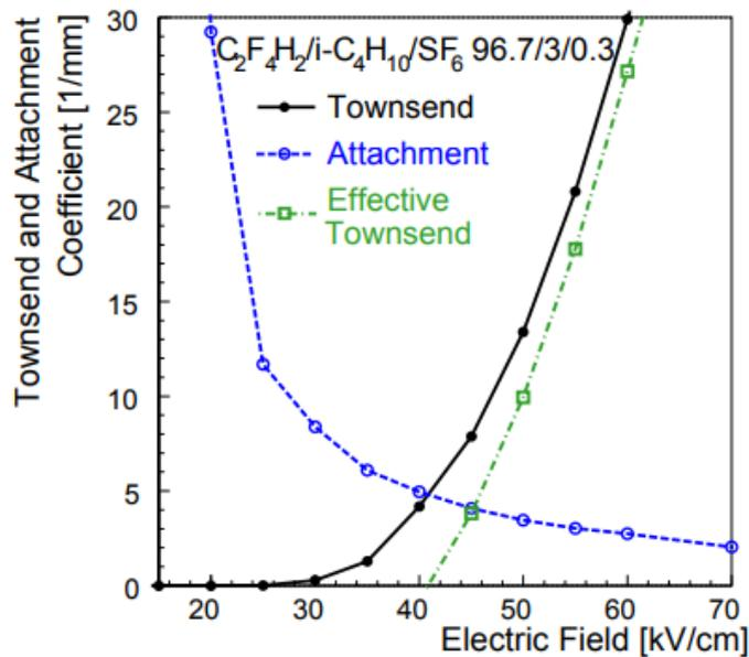
Fig. 4.19 Coefficient de TOWNSEND et coefficient d'attachement calculés grâce à Imonte [35] pour  $T = 296,15$  K et  $p = 1013$  mbar pour un mélange de gaz donné [34].
