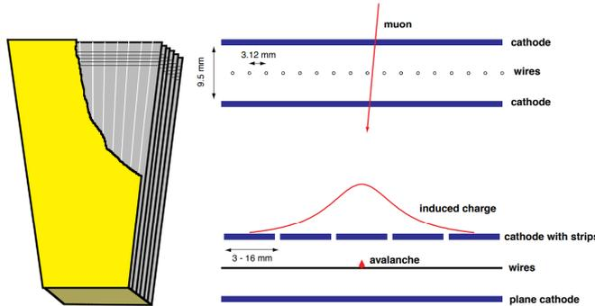
Fig. 3.30 Schéma d'une chambre CSC [17].
