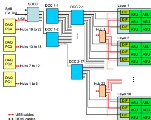
Fig. 5.19 Architecture de la DAQ du SDHCAL. Dans notre cas le nombre d'ASU est d'un par *layer* (chambre) ainsi que d'une DIF par chambre. Le nombre de chambres étant dans notre cas inférieur à 9, l'utilisation des DCC est inutile.
