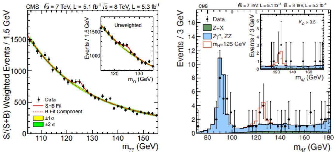
(a) Distribution de la masse invariante en diphoton. Chaque événement est affecté du poids  $S/(S+B)$  de sa catégorie. Les lignes représentent l'ajustement du bruit de fond et du signal, les bandes colorées représentent les écarts-types du bruit de fond à  $\pm 1$  et  $\pm 2\sigma$ .
