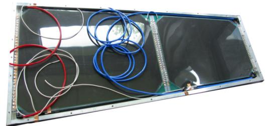
(b) *Gap(ii)* et *gap(iii)* hermétiques formés par collage des verres dans la cassette, avec les *strips* et le *gap(i)* au dessous.
