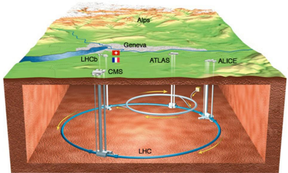
Fig. 2.8 Vue schématique du LHC.
