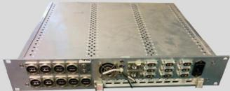
Fig. 5.44 Boîte contrôlable à distance contenant la SDCC etc.
