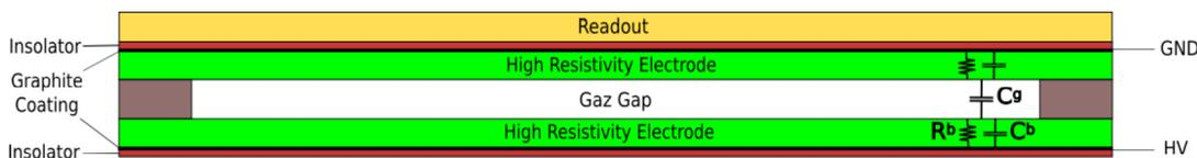
Fig. 4.4 Schéma d'une RPC typique.
