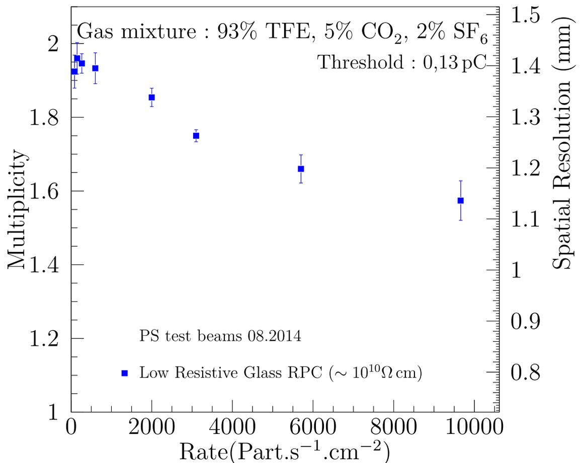
**Fig. 5.31** Multiplicité (axe de gauche) et résolution spatiale (axe de droite) en fonction du flux de particules au point de fonctionnement 7200 V.
