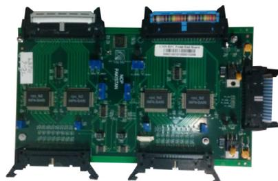
Fig. 4.28 Une *Front-End Board* des chambres RPC dans les bouchons de CMS. Les 4 ASIC sont clairement visibles sur le PCB. Les strips sont reliés aux connecteurs du bas et les signaux *Low-Voltage Differential Signaling* (LVDS) sont envoyés grâce aux câbles reliés aux connecteurs du haut. Le connecteur sur la droite est, quant à lui, relié au *Distribution Board* (DB) et amène la basse tension et les signaux I<sup>2</sup>C.
