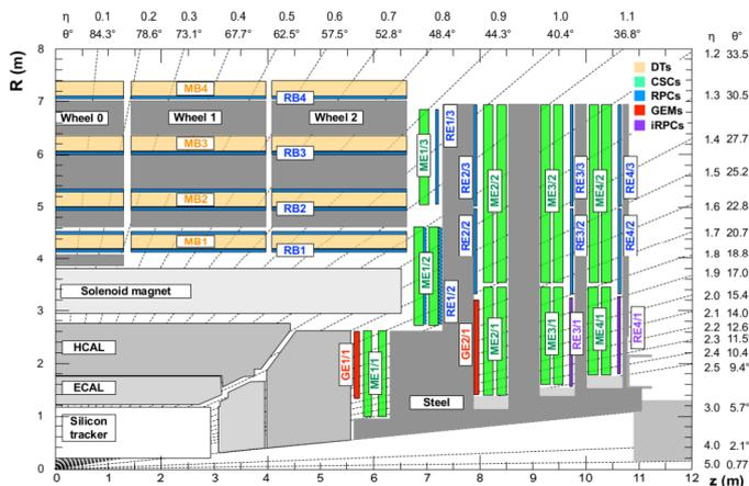
Fig. 3.37 Schéma d'un quart du détecteur CMS montrant les différentes technologies qui seront utilisées dans les bouchons du spectrographe à muons [20].
