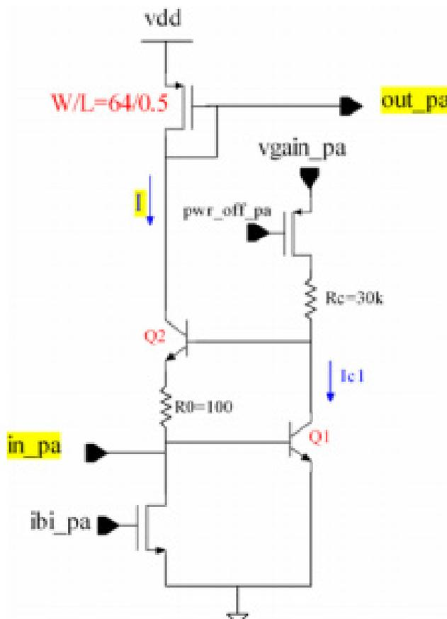
Fig. 5.10 Schéma du préamplificateur.
