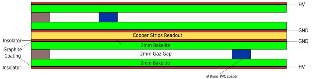
Fig. 4.21 Schéma d'une chambre RPC dans CMS.
