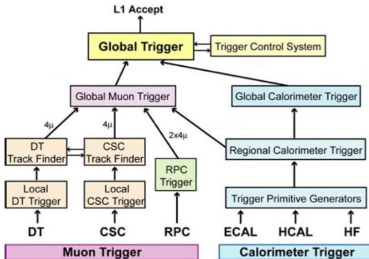
Fig. 3.34 Schéma du Level-1 Trigger (L1) [18].
