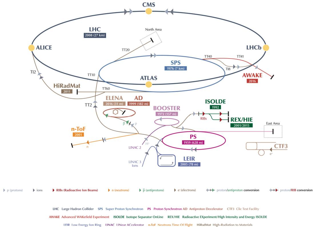
Fig. 2.1 Schéma du complexe d'accélération du CERN. La chaîne d'injection du LHC est constituée du Linac 2, du Booster, du PS et du SPS.
