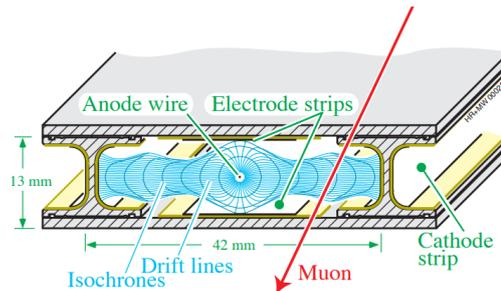
Fig. 3.29 Schéma d'un tube d'une chambre à dérive [16].
