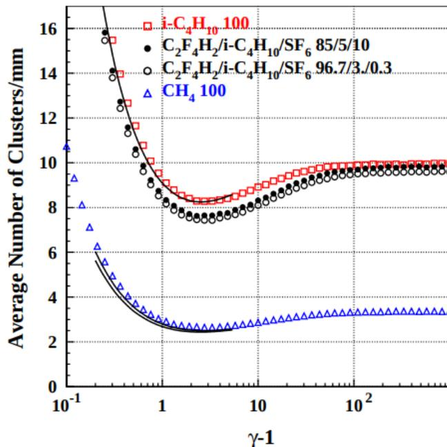
**Fig. 4.17** Nombre de collisions donnant lieu à des ionisations (nombre d'amas) par mm en fonction de  $\gamma - 1$ , avec  $\gamma = \frac{1}{\sqrt{1-\beta^2}}$ , pour différents mélanges de gaz, tel que prédit par HEED [31], avec  $T = 296,15$  K et  $p = 1013$  mbar. Les lignes correspondent à des mesures prises de [33].
