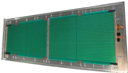
(c) Pose du PCB au dessus du *gap* du bas. On peut remarquer, par transparence, les adhésifs de cuivre (encadrés en rouge sur la figure) reliant électriquement les verres d'un *gap*.
