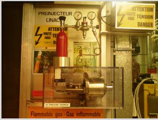
Fig. 2.2 Source de protons du LHC.
