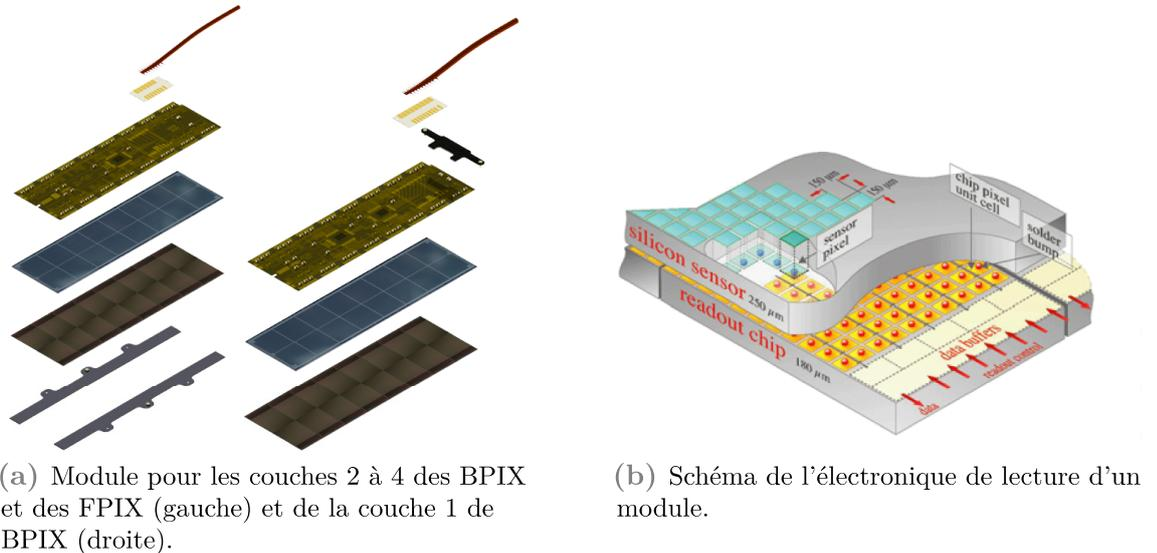
(a) Module pour les couches 2 à 4 des BPIX et des FPIX (gauche) et de la couche 1 de BPIX (droite).
