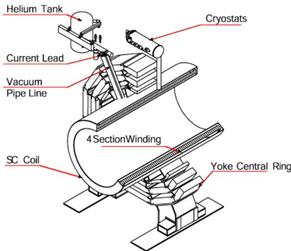
Fig. 3.23 Schéma de l'aimant supraconducteur de CMS [14].
