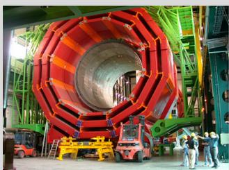
Fig. 3.22 Photo d'une culasse.
