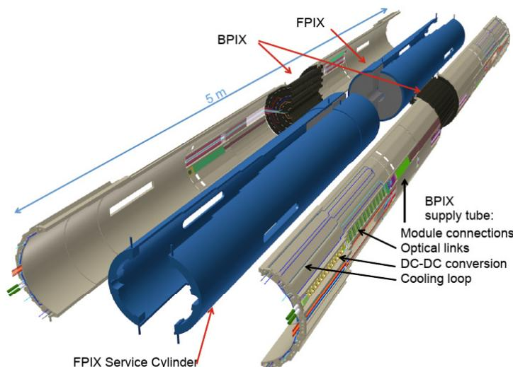
Fig. 3.5 Vue explosée du nouveau détecteur à pixels. La figure montre les positions des différentes partitions FPX et BPIX ainsi que leurs cylindres contenant leurs services respectifs. Les services nécessaires au détecteur (connectiques, fibres optiques, convertisseurs DC-DC) sont situés à haut  $\eta$ , hors du volume de trajectographie [11].
