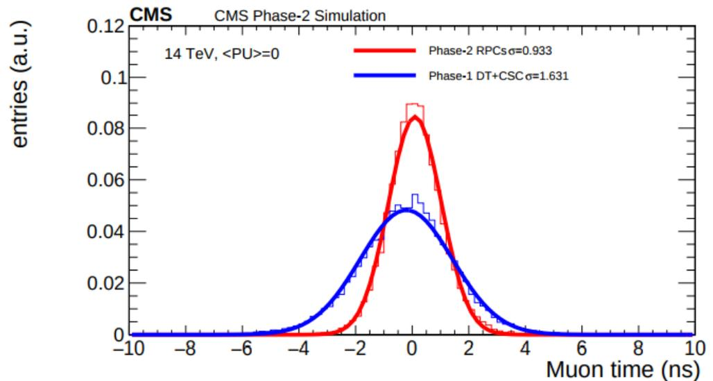
Fig. 4.32 Résolution temporelle simulée pour des traces de muons dans la région vers l'avant, dans le cas où seules sont présentes les chambres CSC et DT (bleu), et dans le cas où les chambres RPC des zones RE3/1 et RE4/1 sont incluses (rouge) [49].
