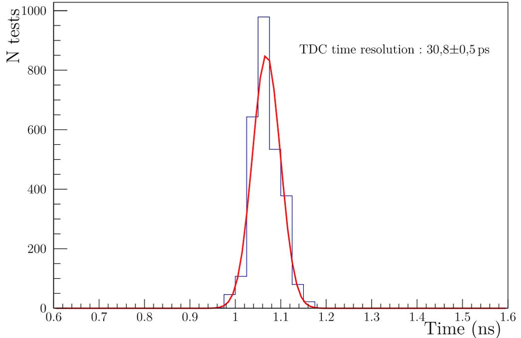
**Fig. 6.7** Résolution temporelle d'un *strip* du PCB. Le signal est un échelon de tension d'amplitude 10 V et de durée 10 ns. Le signal traverse un condensateur de 1 pF.
