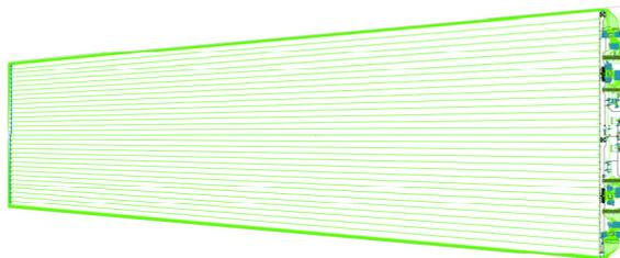
Fig. 6.1 Schéma du PCB permettant la lecture des deux côtés des *strips*.
