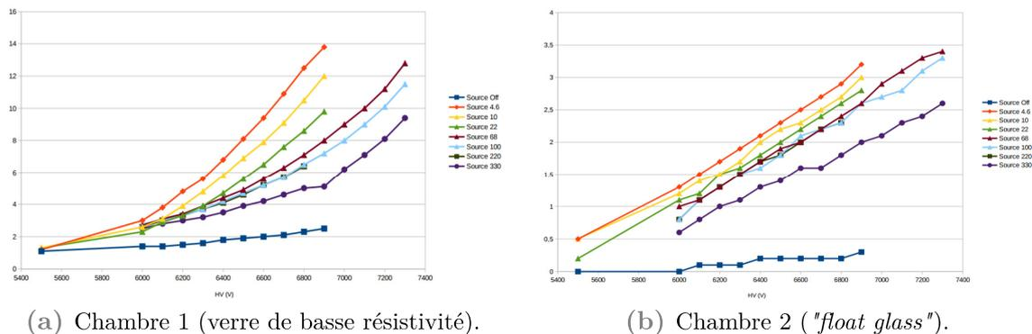
Fig. 5.55 Intensité parcourant les chambres en fonction de la haute tension appliquée pour différentes valeurs du facteur d'atténuation de la source.
