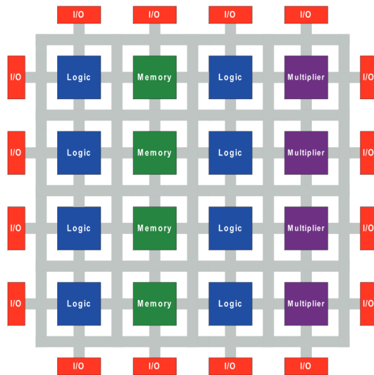
FIGURE 6.1. – Structure générale d'un FPGA, tiré de [KTR08]
