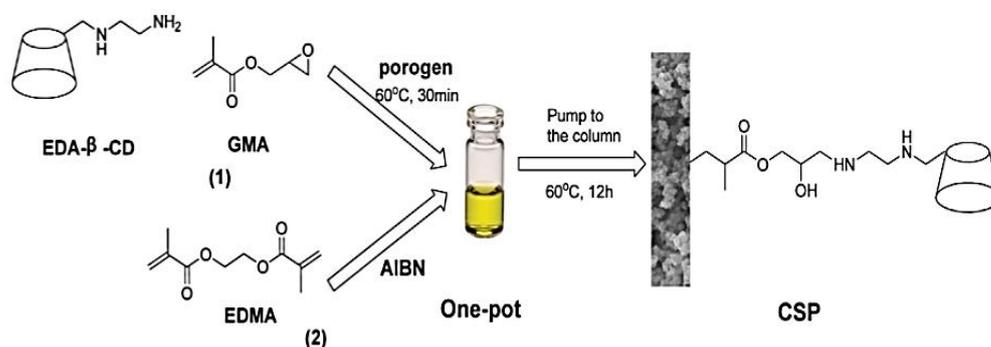
**Figure 37** : Schéma de la préparation en une étape de la CSP monolithique poly(GMA-EDA- $\beta$ -CD-co-EDMA).[184]
