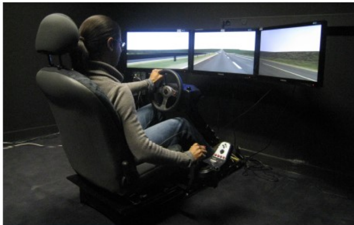
Figure 22 : Simulateur de conduite de la DTer Ouest du CEREMA dans sa configuration 3 écrans
