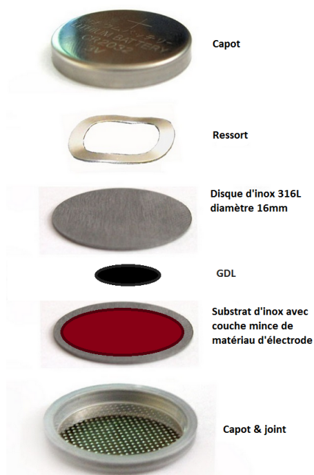
FIGURE C.4 – Vue éclatée des différents composants du montage de conductivité.
