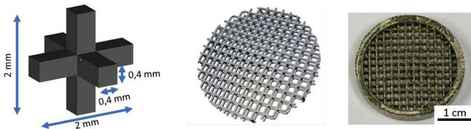
Figure 4-19 : Représentations de la pièce en structure cross. De gauche à droite : schéma d'une maille, CAO de la partie architecturée et macrographie de la pièce élaborée par SLM
