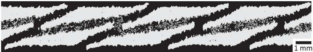
Figure 2-22 : Micrographie optique des trous interconnectés sur une ligne pour un diamètre de 0,5 mm après dépoufrage au blaster puis 20 min d'attaque chimique dans un bain à ultrasons
