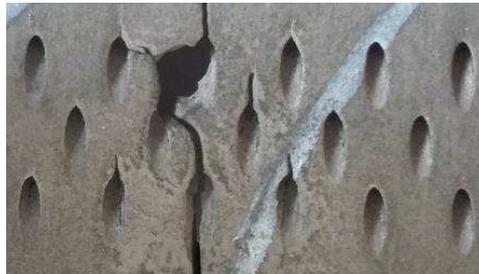
Figure 1-14 : Photographie d'une plaque multiperforée fissurée issue d'une chambre de combustion industrielle (Courtoisie de CRMA®)
