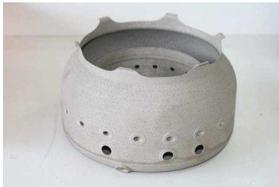
Figure 1 : Chambre de combustion aéronautique élaborée par fabrication additive (« Materials and processes » 2017)
