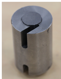
FIG. 3.10: Confinement utilisé pour les essais en compression confinée.
