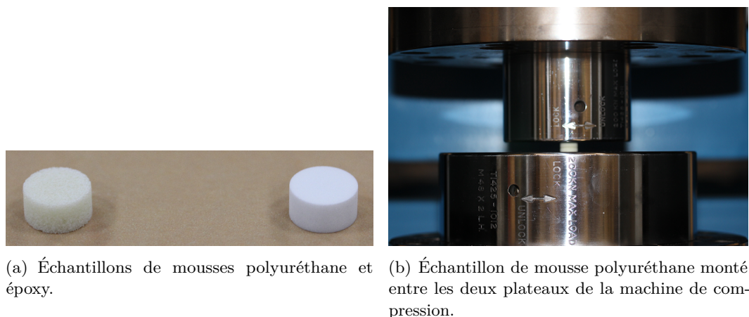
FIG. 3.1: Échantillons testés en compression quasi-statique.
