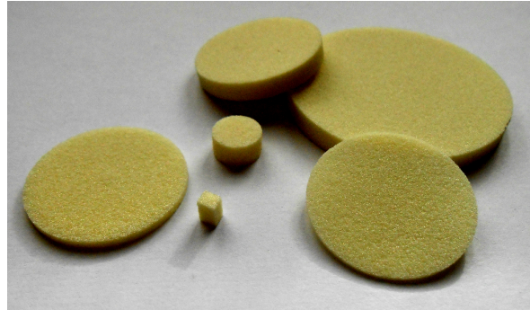
FIG. 2.3: Échantillons de mousse polyuréthane.
