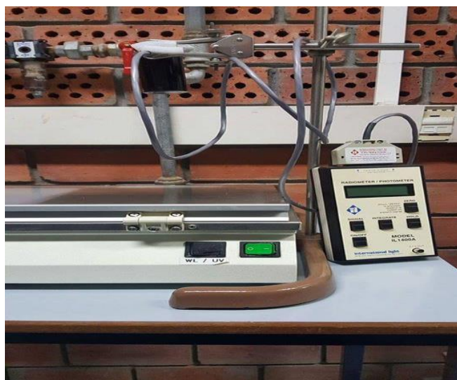
Figure 21. Photo du montage du radiomètre et de la lampe réalisé au sein du laboratoire de radiométrie à l'INSAT.
