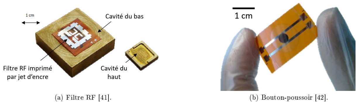
FIGURE 1.10 – Exemple de composants électroniques imprimés par jet d'encre.
