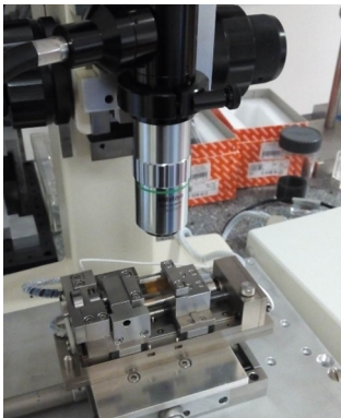
FIGURE 2.21 – Essai de traction sous microscope optique.
