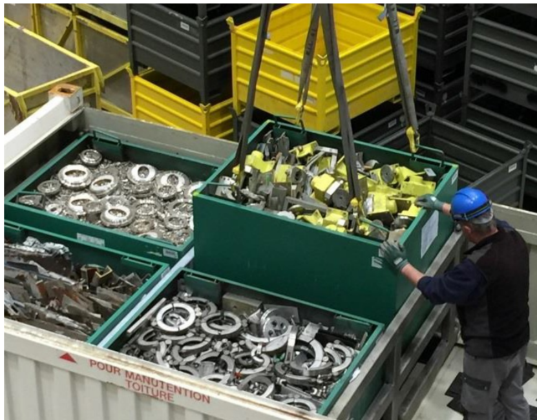
Figure 4: Chargement d'un lot de colis de déchets SHERPA pour expédition en entreposage.
