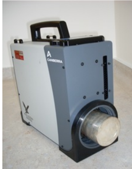
Figure 3: Le Falcon5k est un spectromètre \gamma portable, refroidi électriquement. Ce système de mesure est couramment employé au CERN pour quantifier l'activité des radionucléides ETM dans les colis de déchets radioactifs TFA.
