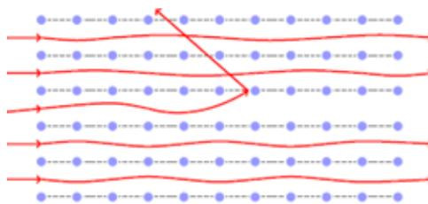
Figure 11: Illustration du phénomène de canalisation
