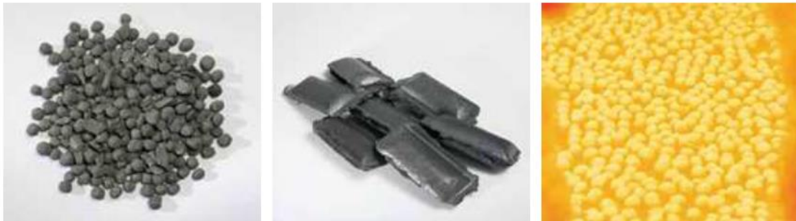
Figure II-2 : Produits du procédé MIDREX : DRI, HBI et Hot DRI (de gauche à droite)
