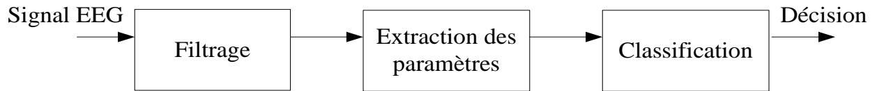
Figure 24. Schéma d'un système automatique de détection des crises d'épilepsie
