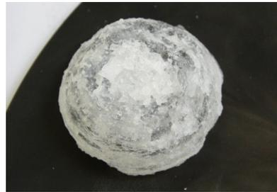
(d) Essai n°3145 sur mousse ( $\sim 12,9$  GPa).
