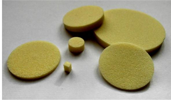
FIG. 2.3: Échantillons de mousse polyuréthane.
