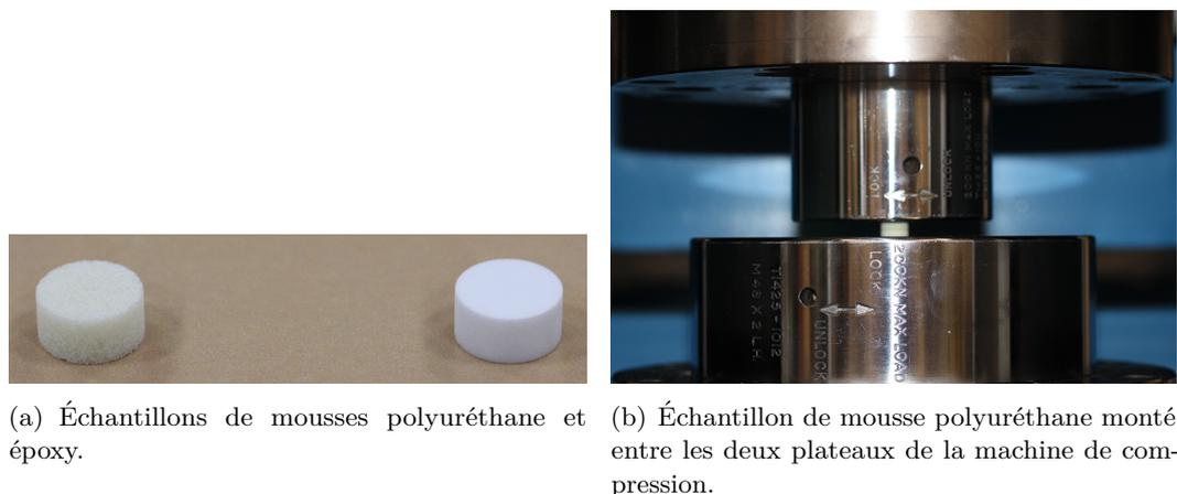
FIG. 3.1: Échantillons testés en compression quasi-statique.
