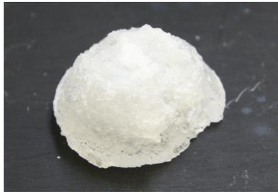
(c) Essai n°3139 sur aluminium ( $\sim 11,8$  GPa).
