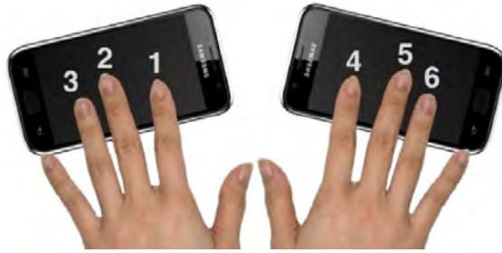
FIGURE 11 – La technique IFD : la main gauche correspond aux points Braille 1,2,3 tandis que la main droite accède aux points 4,5,6.
