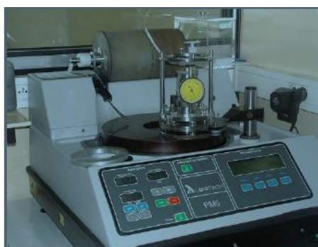
Figure : 1.5 : polisseuse Logitech PM5
