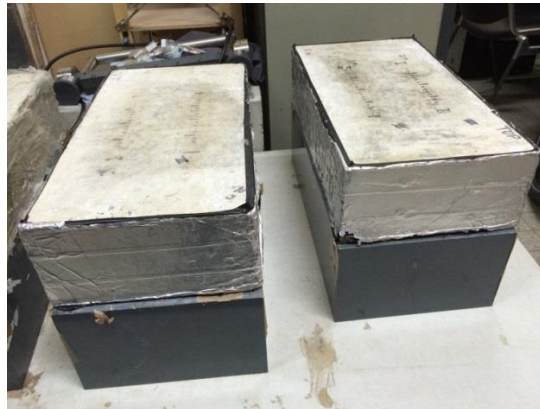
Figure 3. 8: Dispositif expérimental de génération du gradient de teneur en eau vertical permanent
