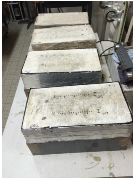
Figure 3. 6 : Les corps d'épreuve fabriqués et conditionnés au-dessus des réservoirs d'eau dans la salle climatisée
