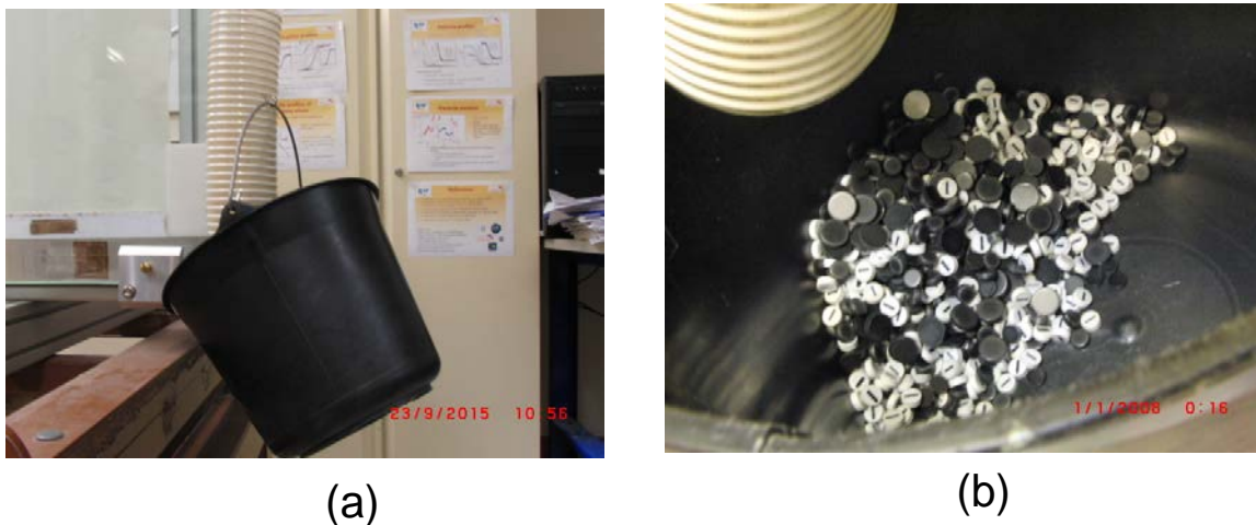
FIGURE 2.5 – Récupération des particules à la sortie du canal : (a) Sceau de récupération, (b) Exemple de particules recueillies en sortie constituées d'un mélange de disques blancs et noirs provenant respectivement du réservoir et du lit statique.
