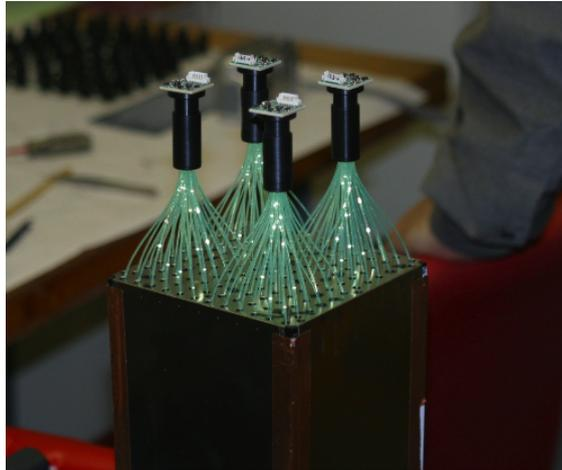
FIGURE 4.12 – Photo d'un module de EMCAL où, pour les quatre tours, le système de collecte de la lumière de scintillation via fibres optiques et le guidage vers les APDs est visible.
