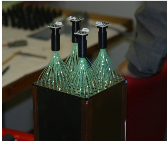
FIGURE 4.12 – Photo d'un module de EMCAL où, pour les quatre tours, le système de collecte de la lumière de scintillation via fibres optiques et le guidage vers les APDs est visible.
