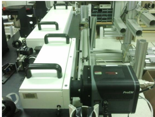
Figure 2-30. Spectromètre SOPRA 1800 traits/mm et la caméra em-CCD.
