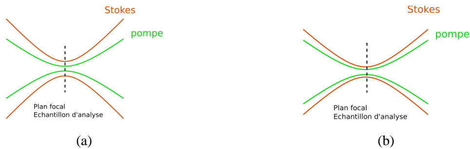
Figure 2-22. Faisceaux Stokes et Pompe au plan focal de la lentille : (a) sans insertion de télescope, (b) avec insertion d'un télescope en voie Stokes.
