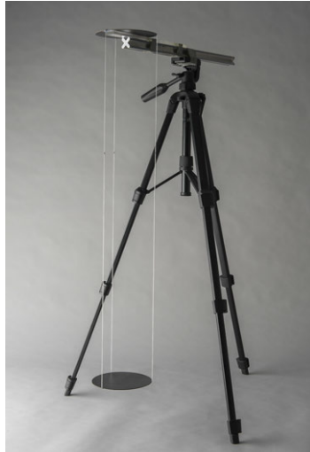
Figure 1.21 – Le pendule trifilaire construit pour estimer les paramètres d’inertie de la maquette.
