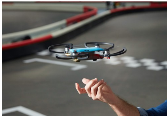
Figure 1.9 – Le nouveau quadricoptère "Spark" de l'entreprise chinoise DJI (leader mondial dans les drones de loisirs), sorti début 2017. Il pèse 300 g, permet des vols automatisés et un pilotage par reconnaissance gestuelle.
