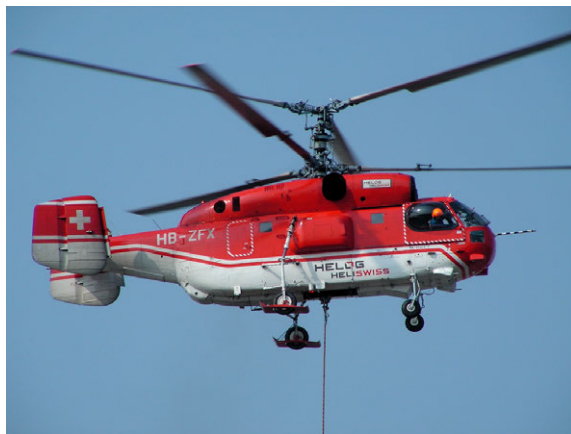
Figure 1.11 – L'hélicoptère "gros porteur" Kamov Ka-32 appartenant la compagnie Heliswiss, pouvant soulever jusqu'à 5 tonnes de charge utile.
