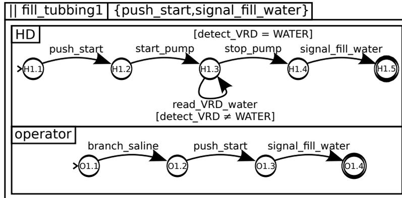
figure 5.17 – Modélisation de la machine à hémodialyse - Deuxième raffinement - Spécification de l'ASTD *fill\_tubbing*<sub>1</sub>
