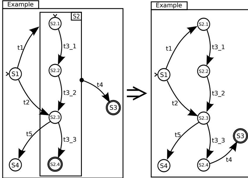
figure 4.9 – Un exemple de réécriture d'un automate
