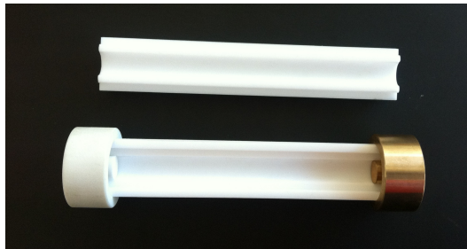
Fig. 8.2 : Photo du moule en 4 parties utilisé pour la synthèse des échantillons longs.
