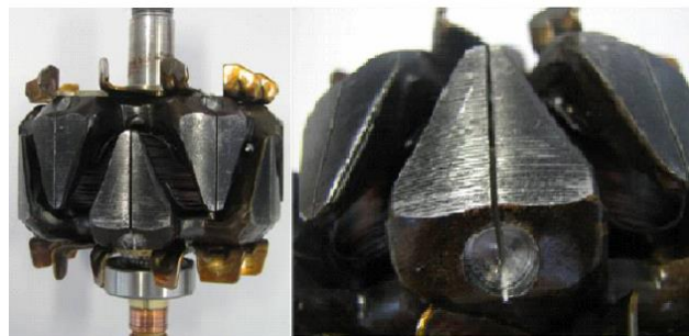
Figure 1.30 : Insertion d'une fente dans les griffes du rotor de l'alternateur [20]
