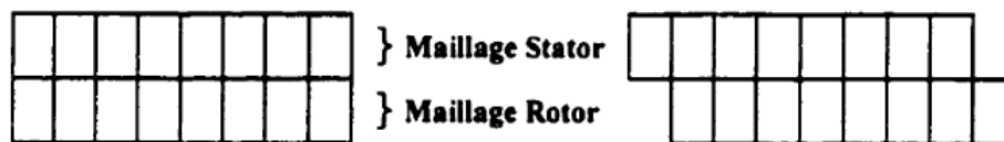
Figure 1.46 : Prise en compte du mouvement par la méthode de ligne d'entrefer [45]
