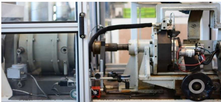
Figure 3.49 : Banc de mesure du couple, de la vitesse, et de puissance des démarreurs
