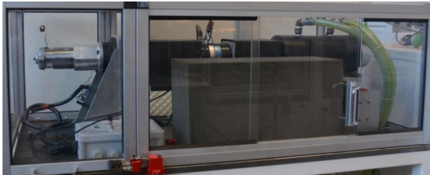
Figure 3.53 : Banc de mesure des pertes mécaniques des démarreurs
