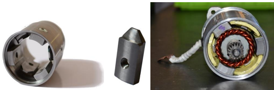
Figure 3.47 : Forme du stator et montage de la machine à griffes 6 pôles / 19 encoches prototypée
