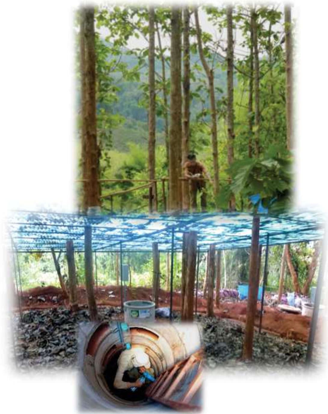
Photo 13 : Assemblage photos illustrant la zone d'exclusion de pluie avec tranchées, toiture et puits d'accès en profondeur
