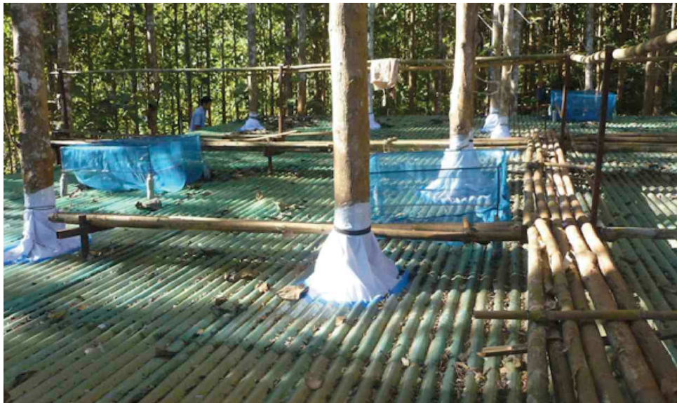
Photo 16: Dispositif de passerelles en bambous permettant d'effectuer les mesures au-dessus de la toiture.
