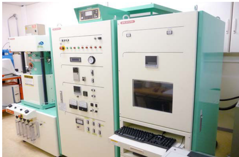
Figure III-10 : SPS Dr Sinter 515S de SPS Syntex Inc. installé à l'IJL.
