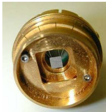
Figure IV-6 : Porte-échantillon utilisé pour les mesures de C_p basses températures (PPMS).
