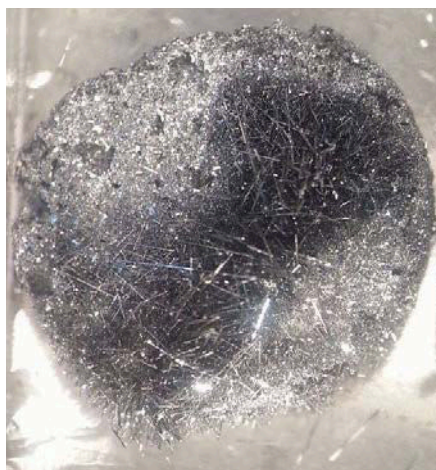
Figure III-22 : Photographie d'une pastille densifiée avec la présence de monocristaux de \text{Pb}_5\text{Bi}_6\text{Se}_{14} sous forme d'aiguilles à sa surface.
