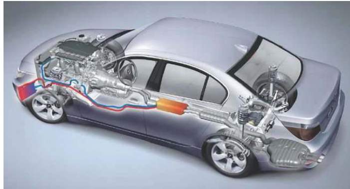
Figure I-7 : Concept d'un générateur thermoélectrique produisant de l'électricité à partir de la chaleur perdue au niveau du pot d'échappement d'un véhicule (source BMW) [21].
