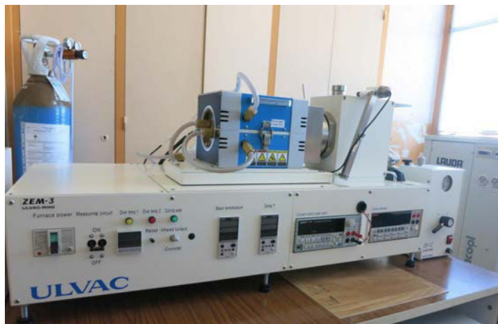
Figure IV-14 : Dispositif de mesure ZEM-3 de l'équipe.
