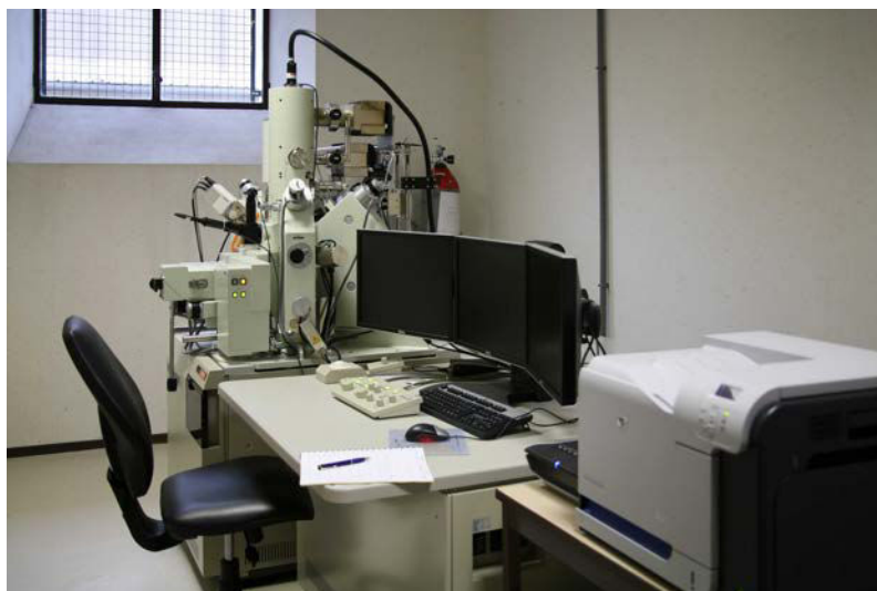
Figure III-16 : Microsonde de Castaing disponible à l'IJL.
