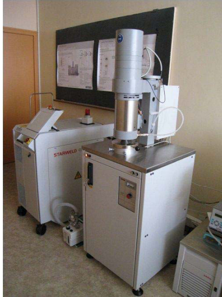
Figure IV-11 : Dispositif LFA 427 (Netzsch) utilisé à l'IJL.
