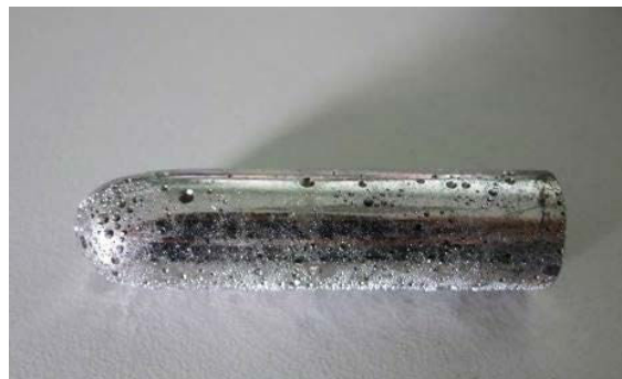
Figure III-4 : Image du précurseur \text{Bi}_2\text{Se}_3 obtenu après synthèse dans un four vertical.
