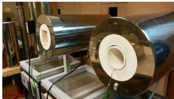
Figure III-6 : Fours de recuit horizontaux.
