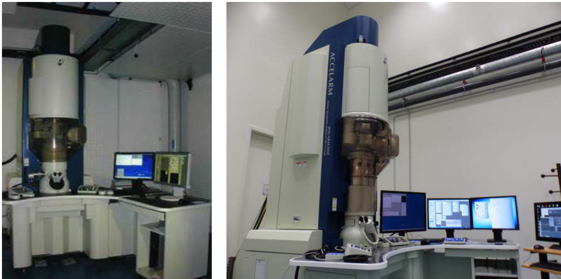
Figure III-17 : Microscopes électroniques en transmission disponibles à l'IJL (a) Jeol ARM200F cold FEG (b) JEM- ARM200F.
