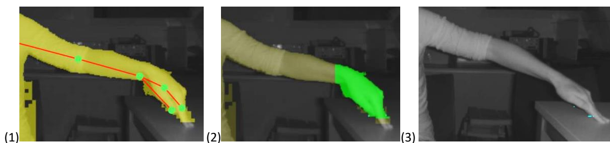
Figure 54 : Exemples de recherche de contacts par zones d'intérêts. (1) Silhouette et squelette numérique fournis par le SDK Microsoft (2) Labélisation de la main droite en vert clair (3) Identification de la zone de contact entre la main et l'environnement (petite interface en pixels bleu clair)
