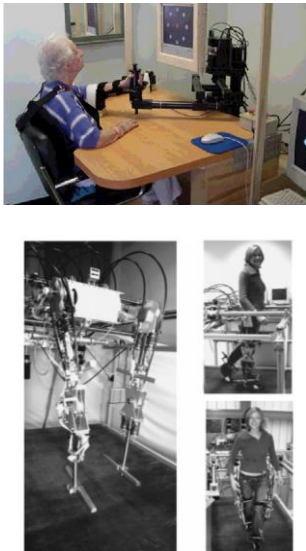
Figure 4: (haut) MANUS du MIT pour le membre supérieur [9] (bas) Exosquelette LOPES pour l'analyse de marche [10]
