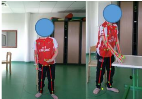
Figure 42 : Captation de l'enfant par le capteur Microsoft Kinect V2
