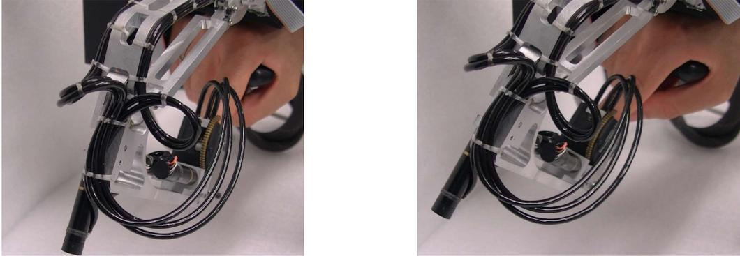
Figure 5.23 : Contact avec une surface normale à l'axe  $Y_{0re}$ .
