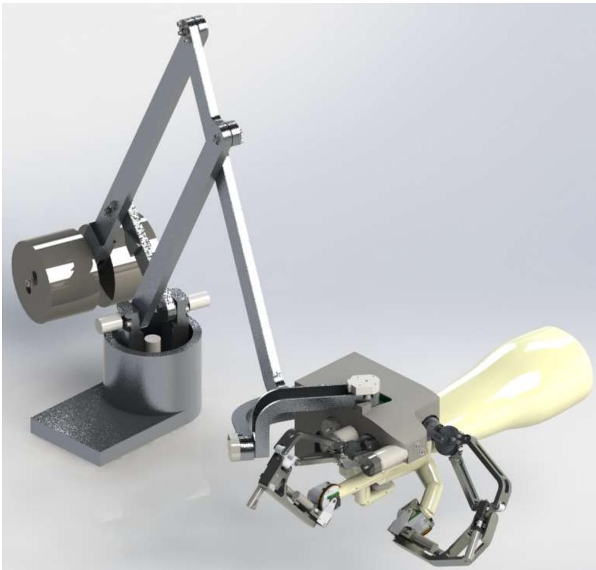
*Figure 4.2 : Vue CAO de l'interface droite à contacts intermittents montée sur son équilibreur.*
