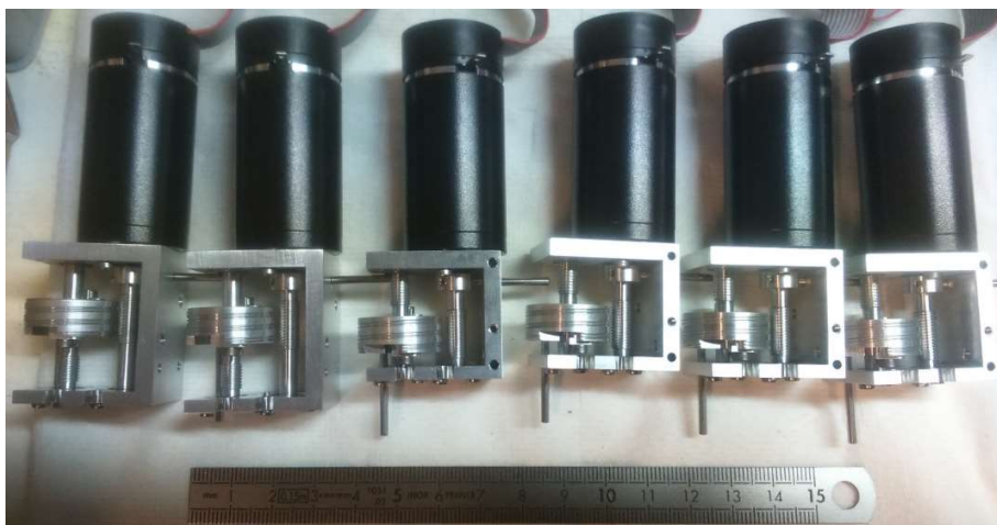
Figure 4.9 : Les 6 motoréducteurs à câbles identiques utilisés sur notre robot.
