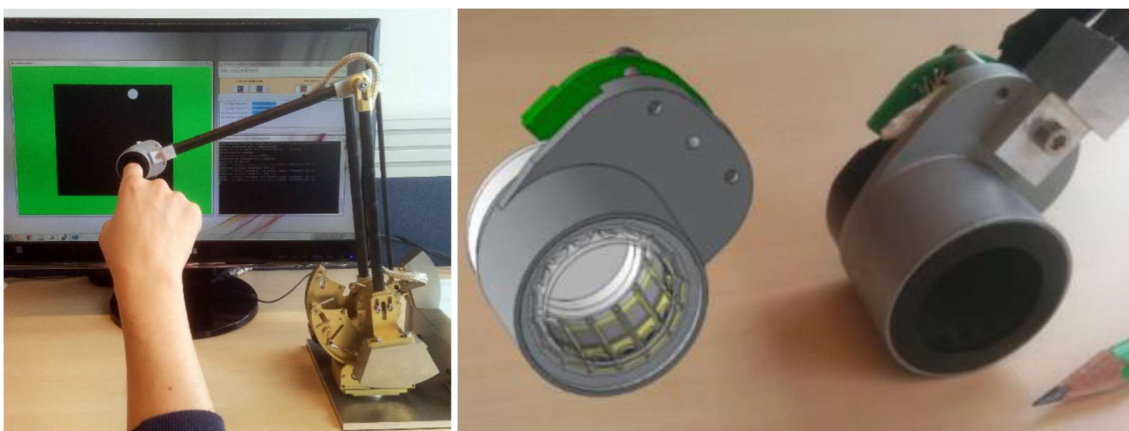
Figure 2.31 : Interface à contacts intermittents du CEA et de l'ISIR (gauche). Zoom sur l'effecteur (droite)
