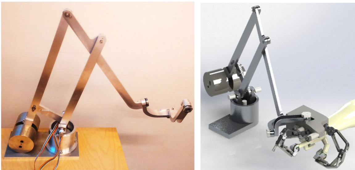
Figure 4.24 : Structure en pantographe utilisée pour mesurer les mouvements de la main et compenser le poids du gant.
