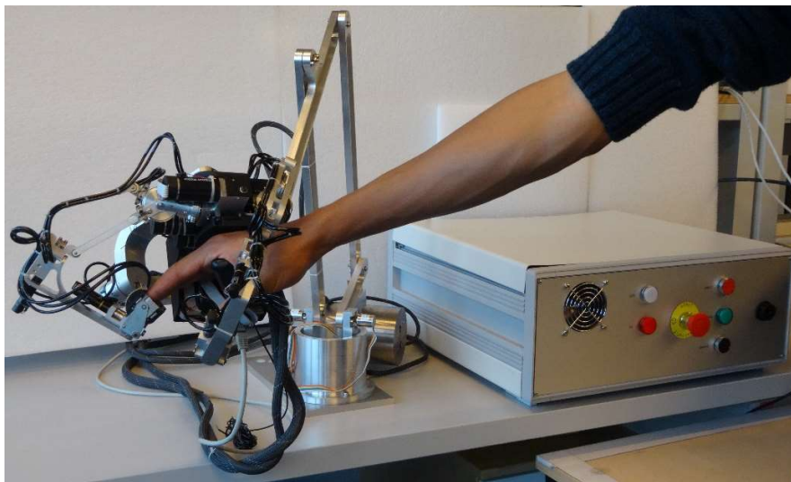
Figure 4.35 : Prototype de gant à retour d'effort à contacts intermittents et son contrôleur.
