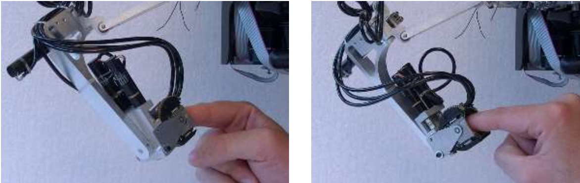
Figure 5.17 : Rotation autour de l'axe Z_{0'e} avec le doigt incliné pour produire un suivi combiné de l'effecteur autour des axes Y_{0'e} et Z_{0'e} .
