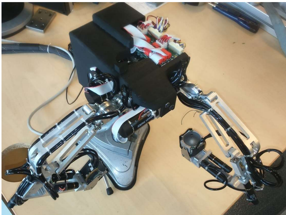
Figure 4.23 : Prototype de gant à retour d'effort à contacts intermittents sur le pouce et l'index.
