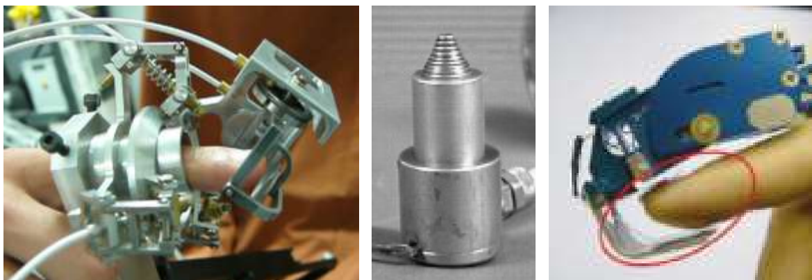
Figure 1.3 : Différentes interfaces se concentrant sur un type d'informations donné. Gauche : interface permettant de modifier l'orientation de la surface de contact avec le doigt [Frisoli et al. 2008]. Milieu : interface permettant de faire varier la surface de contact avec le doigt [Ambrosi et al. 1999]. Droite : interface à contact intermittent [Sato et al. 2007].
