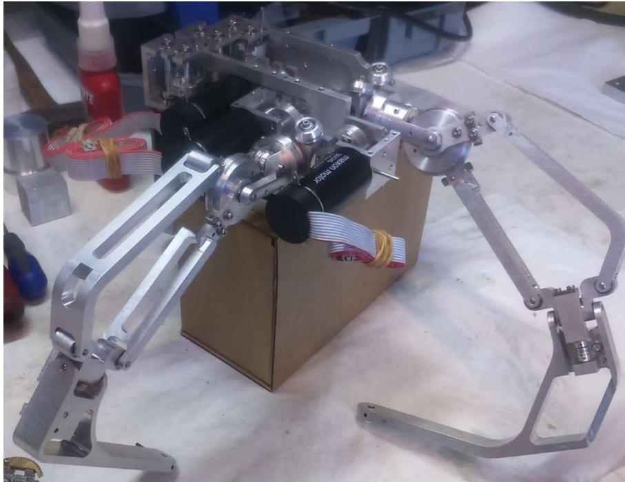
Figure 4.15 : Prototype intégrant les étages de positionnement des capsules du pouce et de l'index.
