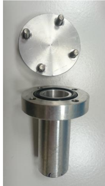
Figure II-11. Réacteur en aluminium utilisé pour l'irradiation des pastilles
