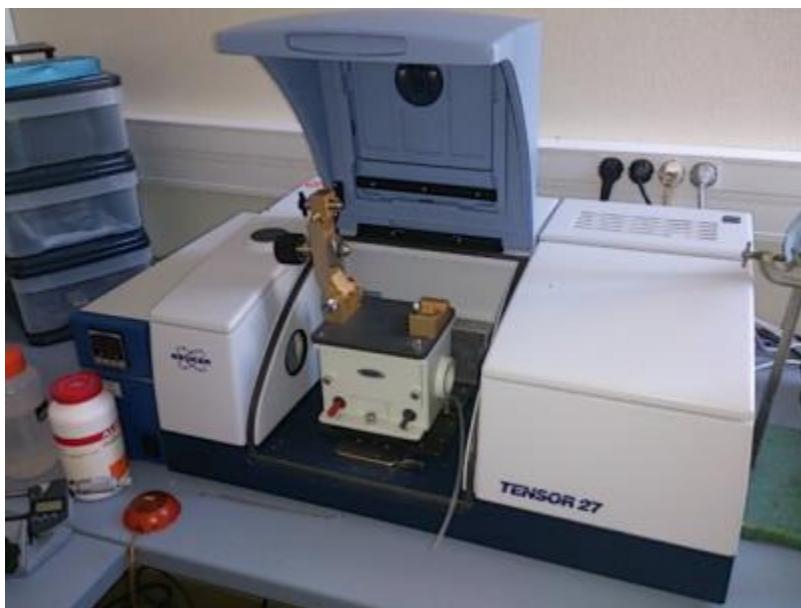
Figure II-14. Spectromètre infrarouge FT-IR Tensor 27 de Bruker équipé avec l'accessoire ATR Golden Gate
