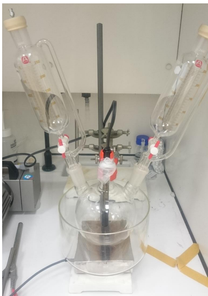
Figure V-2. Montage utilisé pour la synthèse par co-précipitation des hydroxydes doubles lamellaires
