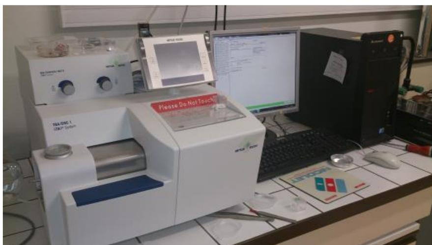
Figure II-12. L'analyseur TGA/DSC 1 de Mettler-Toledo
