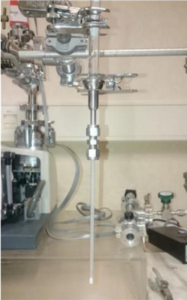
Figure II-10. Tube RPE qui va être scellé sous vide
