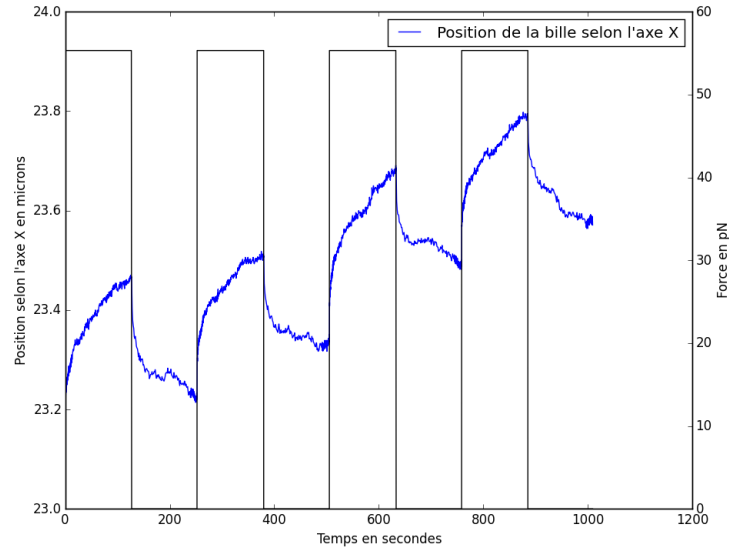
FIGURE 7.2 – Exemple de tracé de la position selon x d'une bille au cours du temps lorsqu'elle est soumise à 4 créneaux de force successifs. \delta R(t) = \delta x(t) lorsque le déplacement ne se fait que selon l'axe X .
