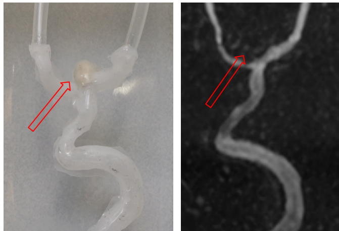
Fig. 3.32 Le fantôme patient-spécifique embolisé: (a) le caillot en plastiline; (b) la MIP de la séquence 3D TOF. Les flèches rouges indique l'anévrisme bouché.
