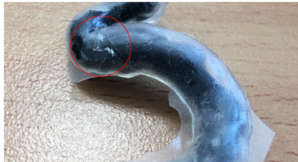
Fig. 2.27 Fantôme détérioré pendant l'extraction de l'âme en résine (le cercle rouge).
