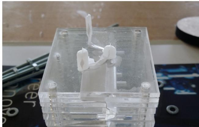
Fig. 2.22 L'ouverture du moule « multi-couche ».
