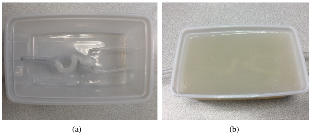
Fig. 3.5 Un fantôme connecté au banc d'essai: (a) avant et (b) après avoir été rempli de gel agar-agar.
