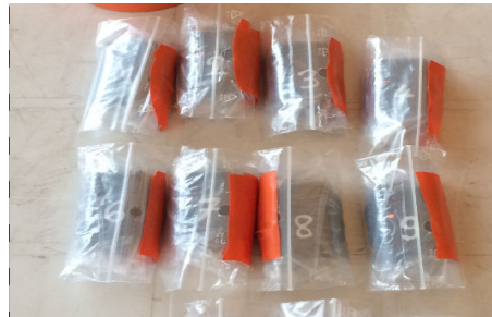
Figure 21: À gauche, sachet utilisé pour étanchéifier les centrales inertielles HIKOB FOX. À droite, résultat final de la procédure d'étanchéification.
