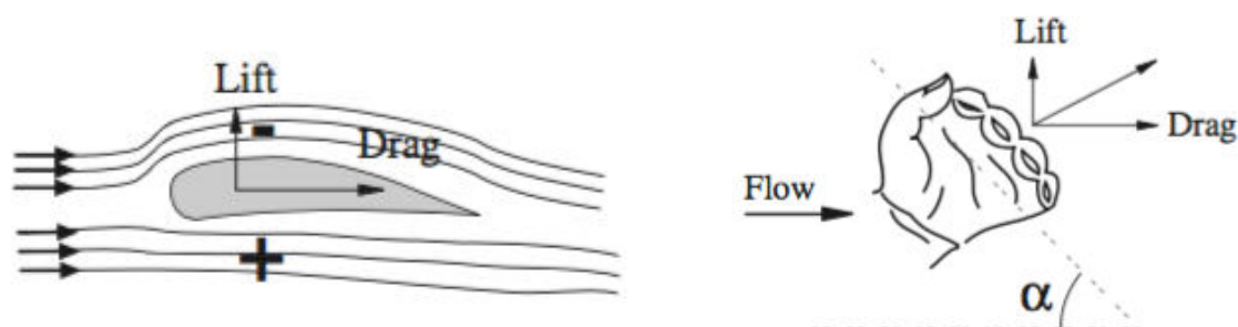
Figure 1: Mise en évidence des forces de traînée (drag) et de portance (lift) sur une représentation schématique de la main (la propulsion correspond à la résultante des deux forces). Extrait de Toussaint et al. (2000).
