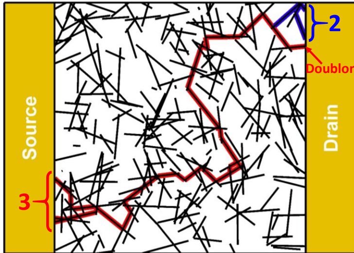
Figure III-6 : Mise en évidence des chemins de percolation suite à une simulation réalisée avec les paramètres suivants : N = 250 , L_c = W_c = 50 \mu\text{m} , L_{NFS} = 6,9 \pm 2,8 \mu\text{m} . 5 chemins de percolation, mis en évidence en rouge et en bleu, ont été obtenus pour une longueur moyenne de chemins de 110 \pm 2 \mu\text{m} et un nombre moyen d'intersections segment/segment de 24 \pm 2 .
