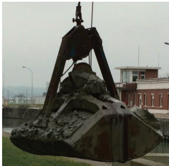
Figure II-1. Prélèvement des sédiments dragués au fond de l'ancienne écluse de Tancarville.
