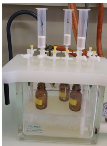
Figure II-6. Mise en cartouche SPE des sédiments préparés avant l'étape d'éluion (procédé MSPD)
