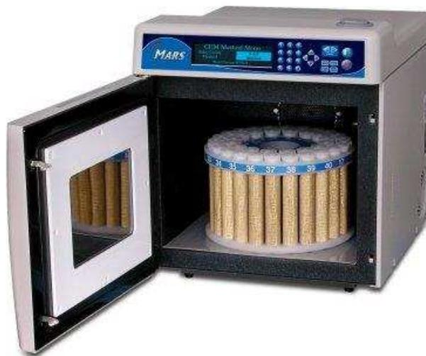
Figure I-3. Vue du dispositif de la méthode MAE.
