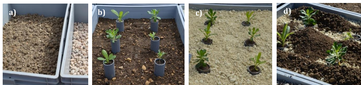
Figure 102 _ Photographies des étapes de remplissage des bacs lysimétriques. a) Remplissage avec le mélange terre/boue, b) Installation des plantes sur la terre, c) Répartition de la boue autour des plantules et d) Installation de la couverture de terre de biopile
