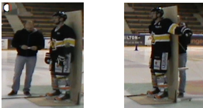
Figure 29. 60 secondes d'immobilité bras le long du corps puis 20 secondes bras en croix posés sur un niveau.
