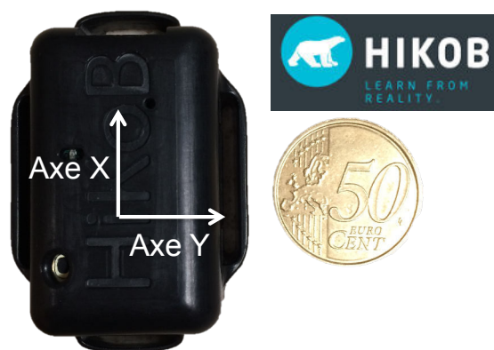
Figure 17. Comparaison entre centrale inertielle Hikob avec une pièce de 50 centimes de 2,4 cm de diamètre. L'axe z ne figure pas sur ce plan, il lui est transversal.
