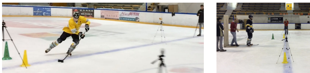
Figure 14. Alignement cellules photo-électriques et caméra sur la ligne de départ des 20m.
