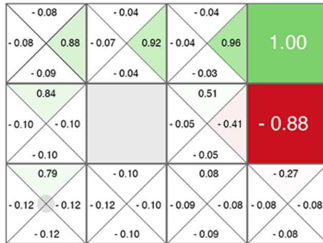
Figure 2.3 – Exemple d’un algorithme Q-learning dans le cadre d’un labyrinthe. La récompense est située en haut à droite, le point de départ en bas à gauche. On observe un gradient depuis l’emplacement de la récompense jusqu’au point de départ. Ce gradient est une schématisation de l’atténuation de la prédiction de la récompense dépendamment des actions. Figure reproduite de Q-learning 2016
