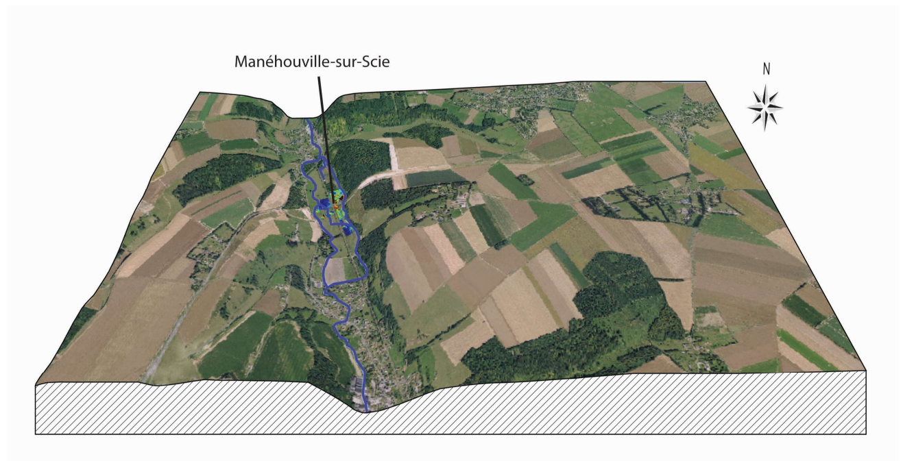
Figure 5.3 : Modèle numérique de terrain du secteur d'investigation et implantation des données géophysiques (réalisation : Gonnet 2015, MNT réalisé avec Qgis et Grass. Exagération verticale x 5. Fond de carte : BD ortho 76 5m. MNT : BD alti RGE IGN 5m. Géophysique : Geocarta 2013
