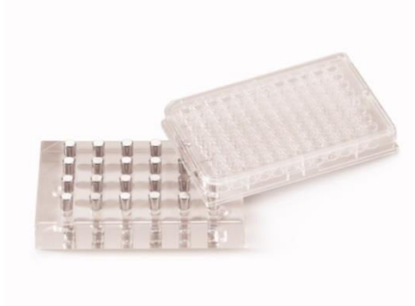
Figure 4 – Aimant utilisé lors de la purification avec les billes AMPure XP.
