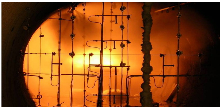
Aspersion par brouillard d'eau lors d'un essai dans le tunnel à échelle 1/3 du CSTB
