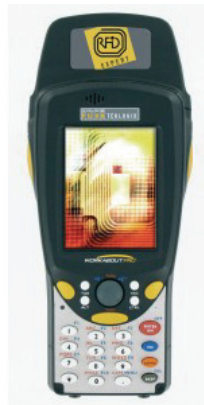
Figure 4.10 : Le PDA industriel WORKABOUT PRO S avec lecteur RFID intégré
